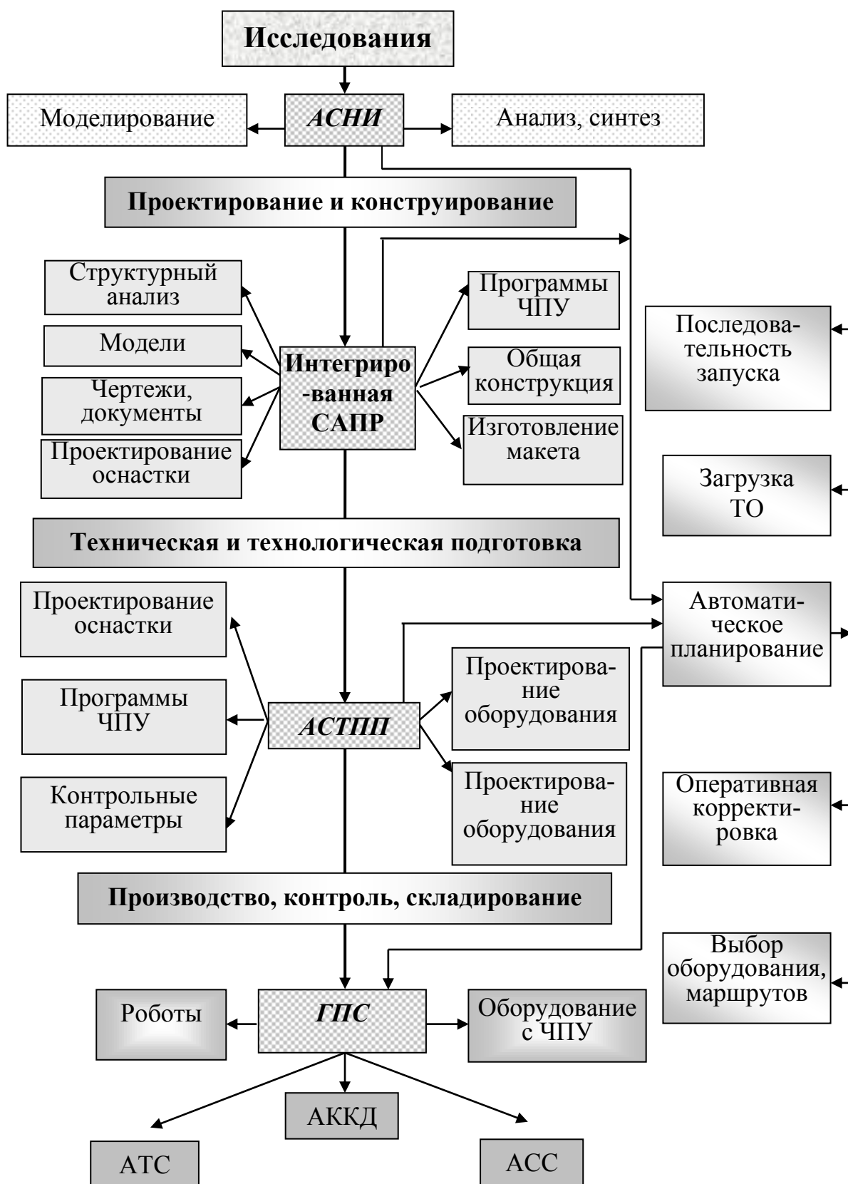
Рис. 9.2. Структурная схема гибкого автоматизированного производства.
