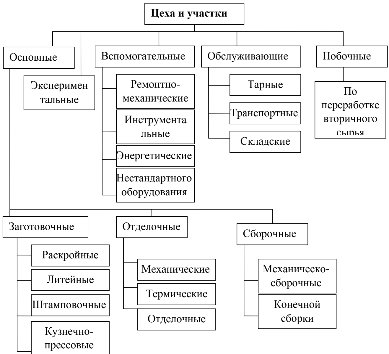
Рис. 2.2. Производственная структура машиностроительного предприятия
