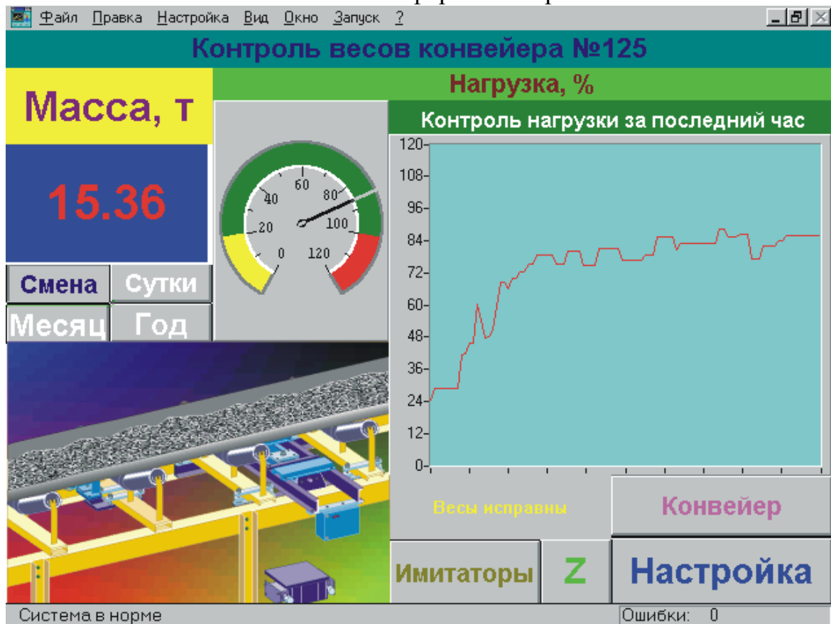
Рис.5.6. Пример интерфейса оператора конвейерной линии в Genie.
